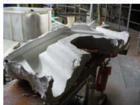
Figura 54 Controforma in gesso ultimata e rifinita.
