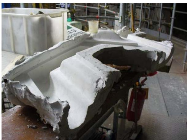
Figura 54 Controforma in gesso ultimata e rifinita.
