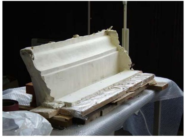
*Figura 43 La controforma in gesso è stata rifinita in laboratorio per eliminare tutte le piccole imperfezioni.*
